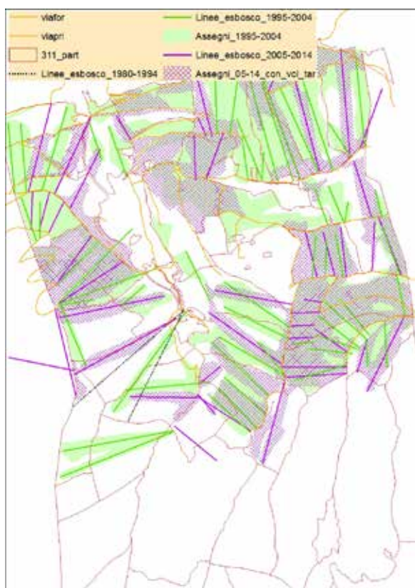
ASUC di Pellizzano: linee di teleferica e aree percorse con le utilizzazioni dal 1980 al 2013
