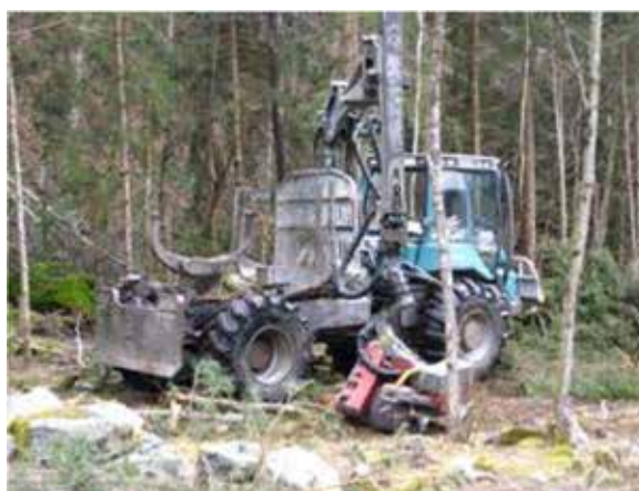
Per il taglio delle piante è stato utilizzato uno Skidder con testa Harvester
