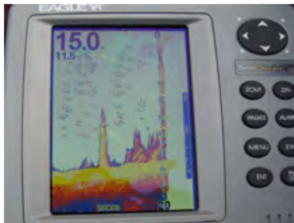
Immagine da ecoscandaglio che rivela la presenza di pesci a diverse profondità nel lago di Santa Giustina
