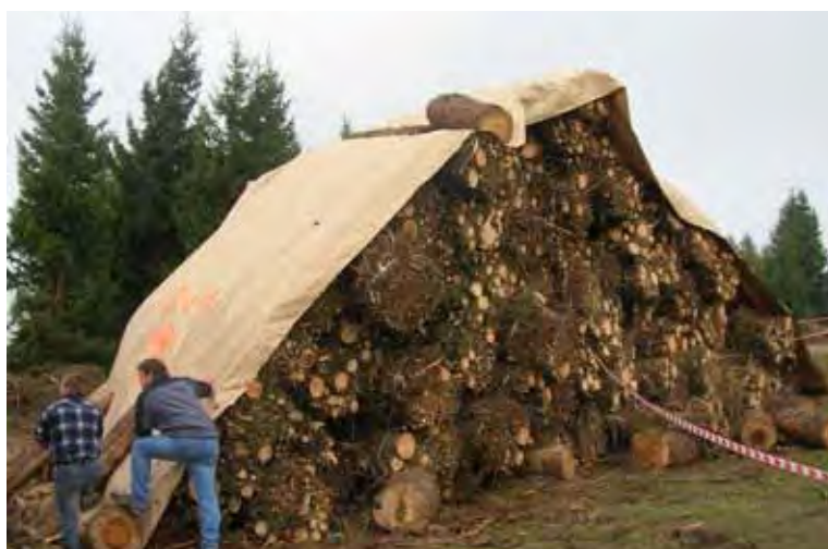
Sperimentazione di telo protettivo per fasci imballati
