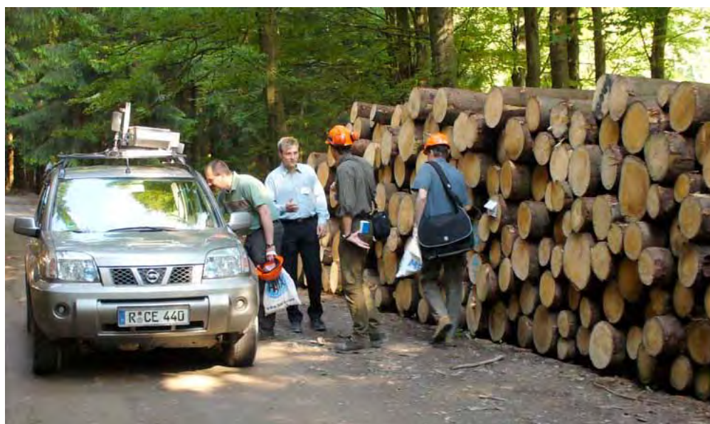
Strumento per la scansione laser della catasta, montato su autoveicolo
