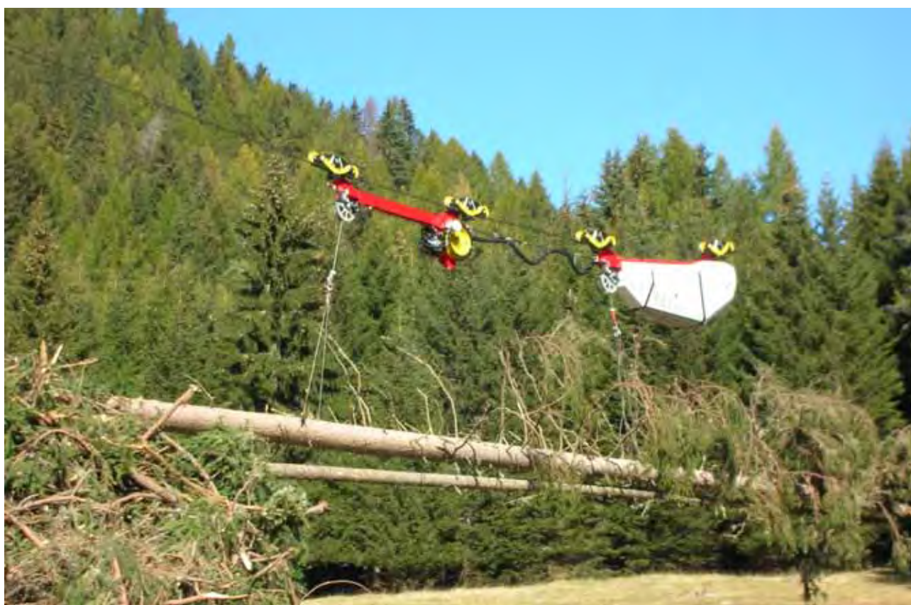
Il carrello doppio può caricare orizzontalmente la pianta da esboscare
