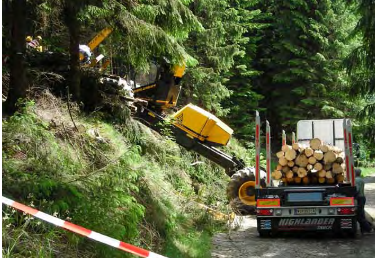
Il continuo aggiornamento del personale dell'Incarico Speciale comporta la partecipazione a dimostrazioni tecniche all'estero per la formazione e la consulenza tecnica forestale, come in questo caso, AUSTROFOMA 2009 : dimostrazione di uno speciale Harvester di montagna per lavorare su pendenze elevate, con cabina autolivellante e braccio che lavora a 360°
