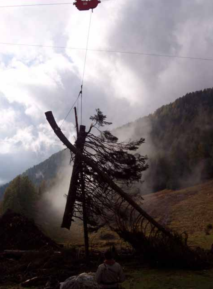
L'esbosco con gru a cavo è il sistema più comunemente adottato nelle aree di montagna meno servite da viabilità
