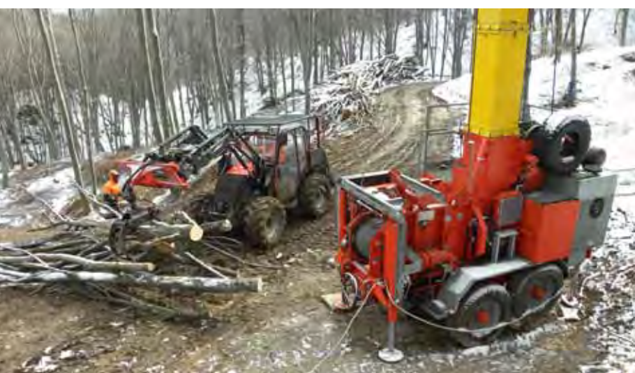
Cantiere di taglio ed esbosco con gru a cavo mobile (Vezzano)
