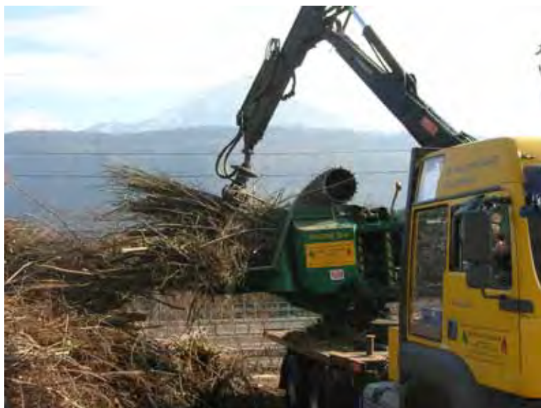
In funzione la macchina imballatrice di ramaglia montata su autocarro
