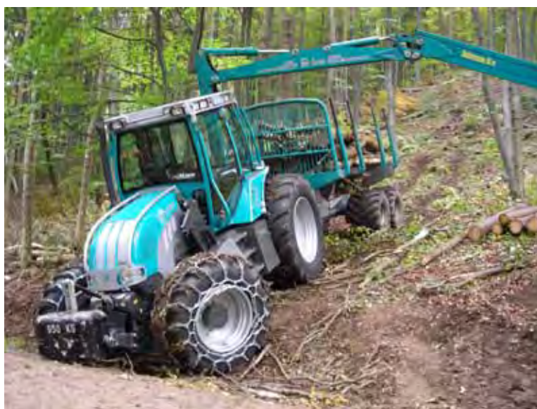
Esbosco con trattore forestale specializzato per l'operabilità su elevate pendenze
