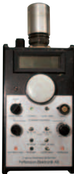
Figura 4.18 - Rilevatore di ultrasuoni modello Pettersson D980 che consente di trasformare gli ultrasuoni in suoni udibili all'orecchio umano. È possibile lavorare con tre diverse modalità di ricezione: eterodina, divisione di frequenza ed espansione temporale.
