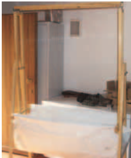
Figura 4.4 - Harp trap con telaio di legno. I fili di nylon tesi tra i due supporti verticali interrompono il volo dei chiroterri che cadono all'interno del tascone inferiore, dal quale possono essere facilmente catturati (Foto D. Preatoni).
