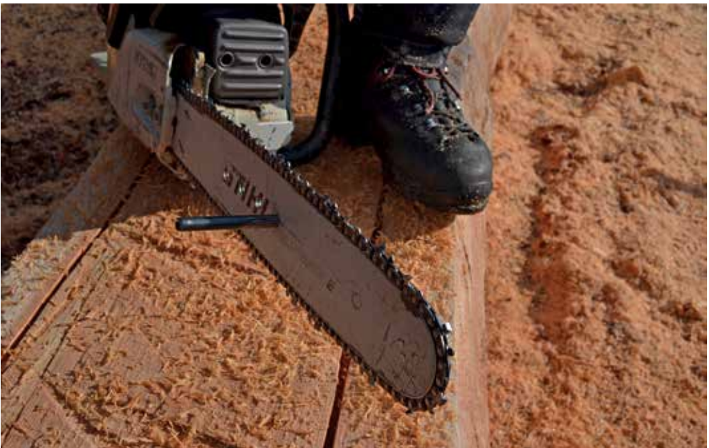
sgrossatura e dimensionamento della vasca: motosega con limitatore di profondità, 2015 - foto Paolo Aloisi e Davide Pozzo
