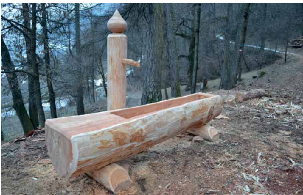
preparazione colonna, fresatura per alloggio della tubazione idrica, finiture superficiali e montaggio dei pezzi: fresa su trapano, fer a do'man , motosega, 2015 - foto Paolo Aloisi e Davide Pozzo
