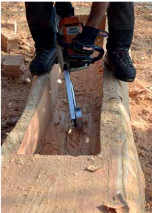
scavo della vasca, preparazione degli appoggi e "collaudo del piano d'appoggio": motosega con limitatore di profondità, zapin , scavadòr dele canàle , pialla , fresa su motosega , 2015 - foto Paolo Aloisi e Davide Pozzo
