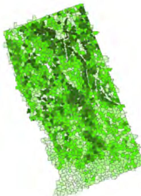
Mappa dei volumi per ettaro per poligoni omogenei dell'area di studio di Paneveggio elaborata utilizzando dati LiDAR ad alta densità di punti. Scala crescente da verde chiaro (50 m<sup>3</sup>/ha) a verde scuro (1.300 m<sup>3</sup>/ha)
