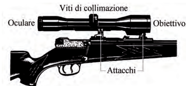
Fig. 9 Cannocchiale posizionato su fucile a canna rigata
