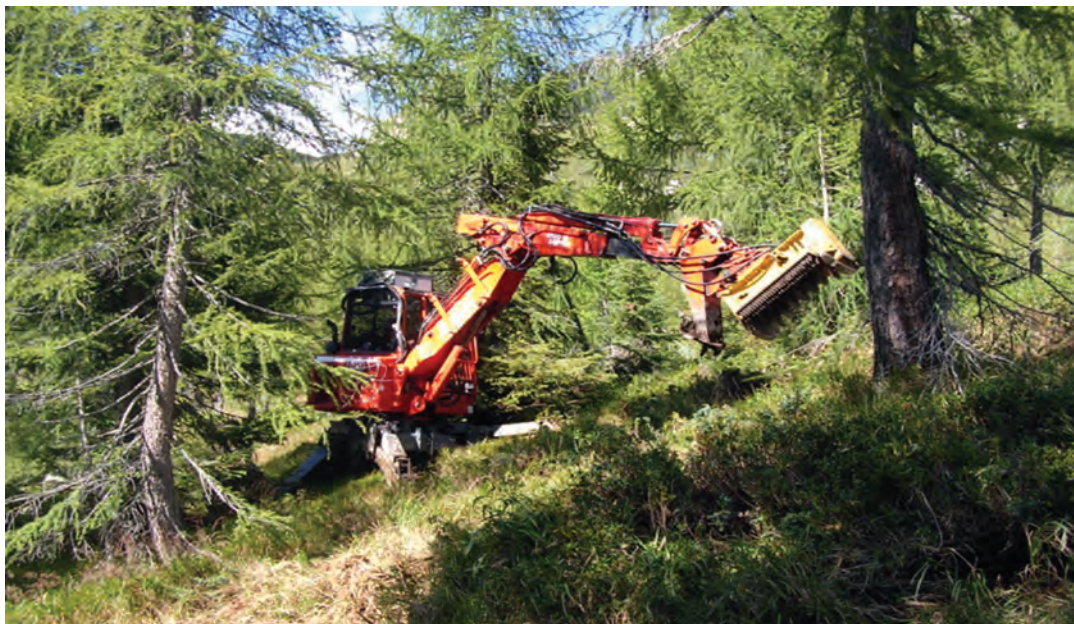
Figura 31 Escavatore tipo ragno munito di trinciatrice impegnato nel taglio del Rododendro (foto Andrea Boso).
