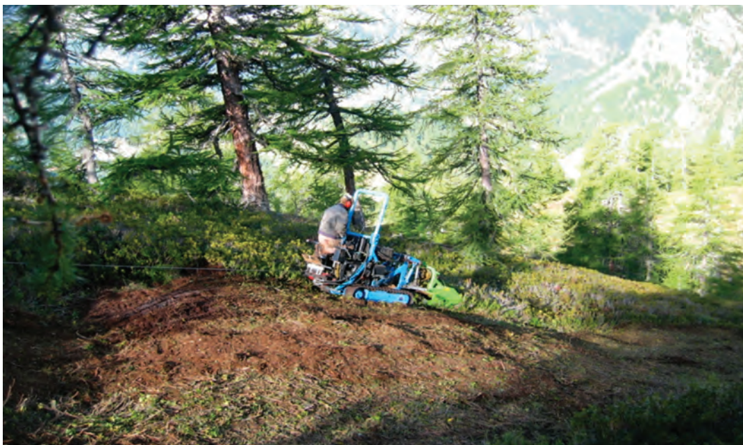
Figura 30 La stessa macchina, già descritta nella foto precedente, impegnata nel taglio del Rododendro su di un versante piuttosto ripido e per questo ancorata con un verricello ad una pianta. Dopo il suo passaggio, la vegetazione è stata completamente triturrata, senza rendere necessarie altre lavorazioni (foto Luca Rotelli).
