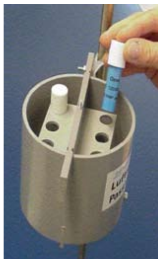
Campionatore passivo per l'ozono nell'apposito supporto
