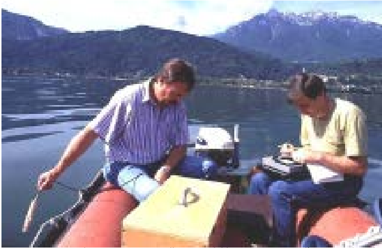
Ossimetro. La sonda viene immersa nelle acque del lago per misurare l'ossigeno disciolto alle diverse profondità.
