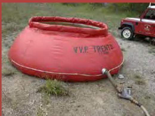
A supporto dell'estinzione a terra e nella fase di bonifica si fa diffuso ricorso anche a piccole vasche mobili prefabbricate, elitrasportabili, con capacità ridotta (2-3 m<sup>3</sup>) in materiale plastico con o senza armatura metallica che possono essere trasportate ripiegate, montate e smontate in pochissimo tempo. Questi tipi di vasche sono inoltre molto utili per la formazione di condotte provvisorie costituite da manichette e motopompe in serie.
