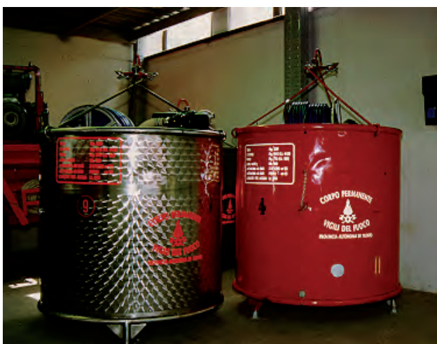
Figura 9.3 - Moduli elitransportabili, formati da serbatoio, motopompa e naspo
