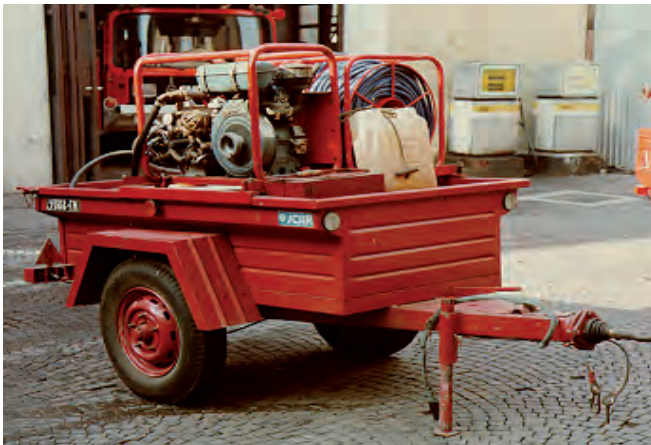
Figura 9.6 - Carrelli specifici per la lotta attiva agli incendi boschivi, dotati di serbatoio, motopompa ad alta pressione e naspi di piccola sezione
