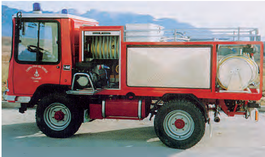
Figura 9.5 - Autobotti leggere e medie con pompe di diverse caratteristiche, dotate di manichette e di lance di irrorazione
